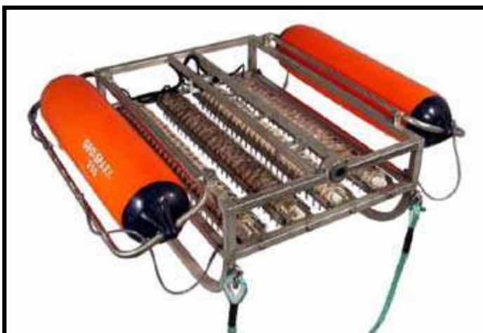
Fig. 2.17 Sorgente sismica di tipo Sparker trainata dalla nave.
