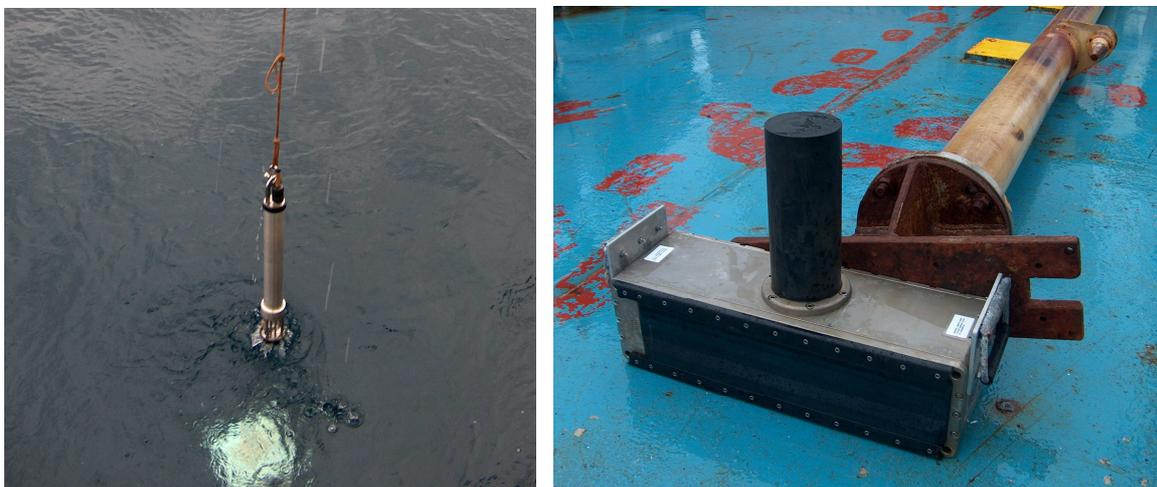
Fig. 2.4 Messa in mare della sonda SVP (a sinistra) e trasduttore multibeam 8125 (a destra).
