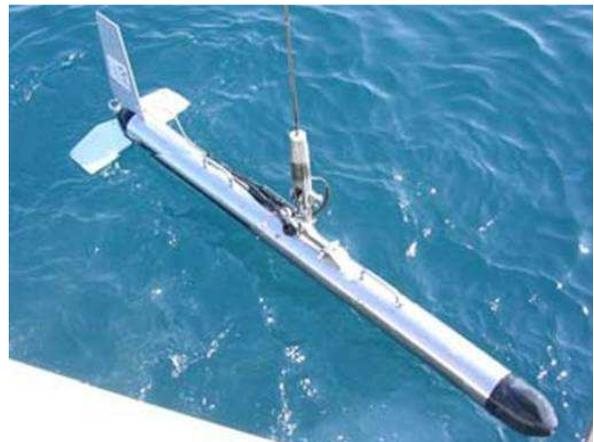
Fig. 2.13 Acquisizione di dati morfobatimetrici con il SSS (sinistra) e dettaglio del "pesce" (destra).
