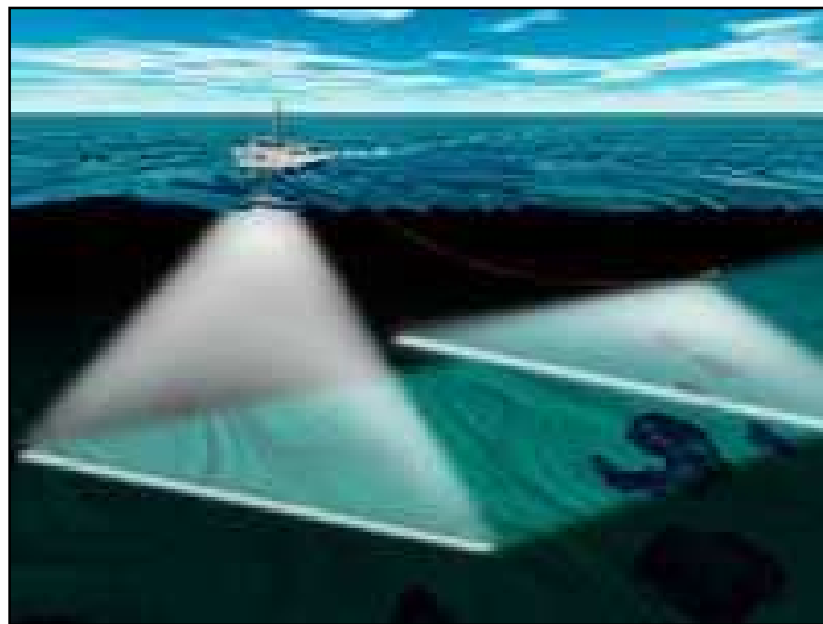
Figura. 3.3.1). Strumentazione Multibeam, posizionata sotto lo scafo dell'imbarcazione e Side Scan Sonar, trainata dalla nave tramite l'utilizzo di un apposito cavo di traino.
