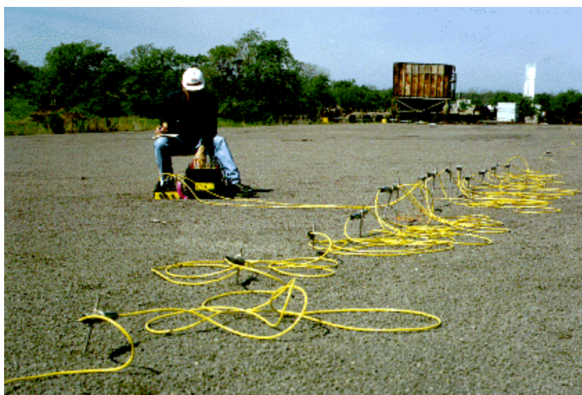
Figura 7 - Indagine geoelettrica con Sting-Swift.
