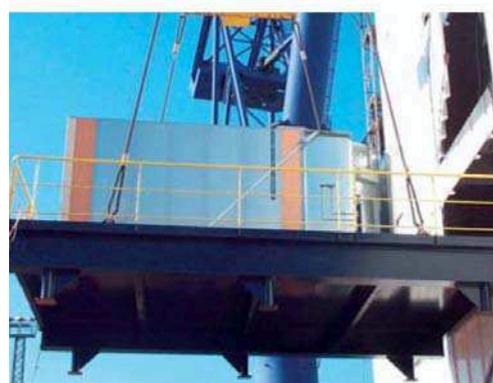
Figura 5 - Cabina modulare nave da crociera
