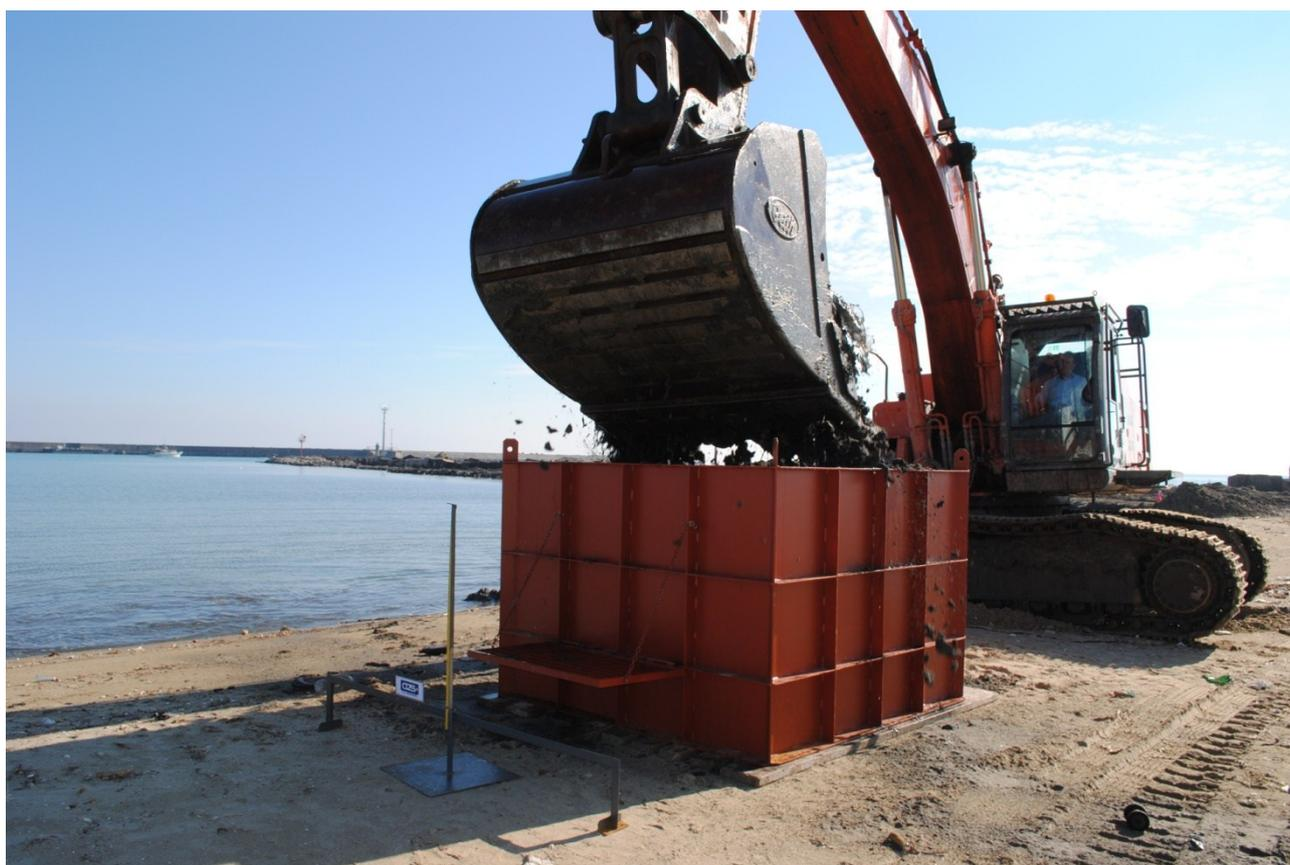
Figura 6.22 – Vasca di prova in sito – fase di riempimento
