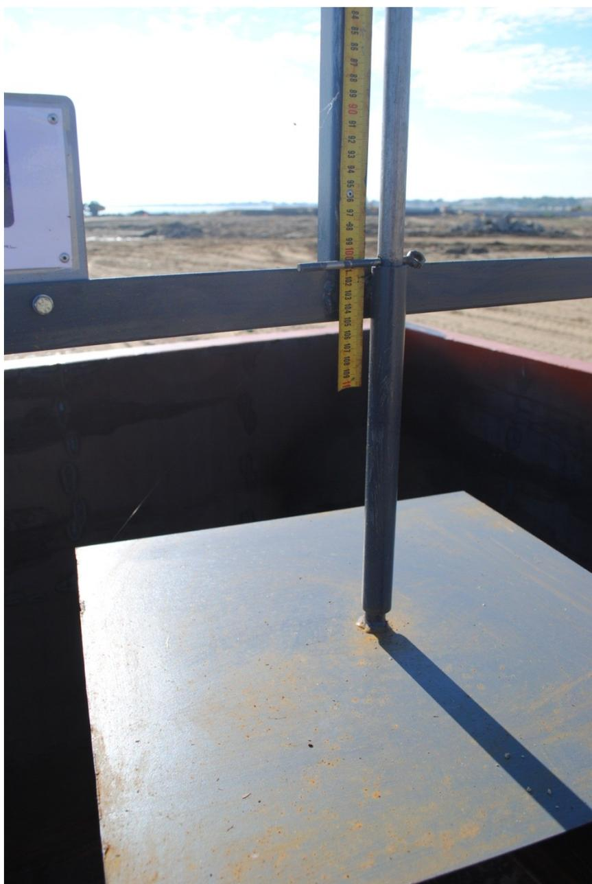
Figura 6.20 – Vasca di prova in sito – asta graduata per rilievo abbassamenti
