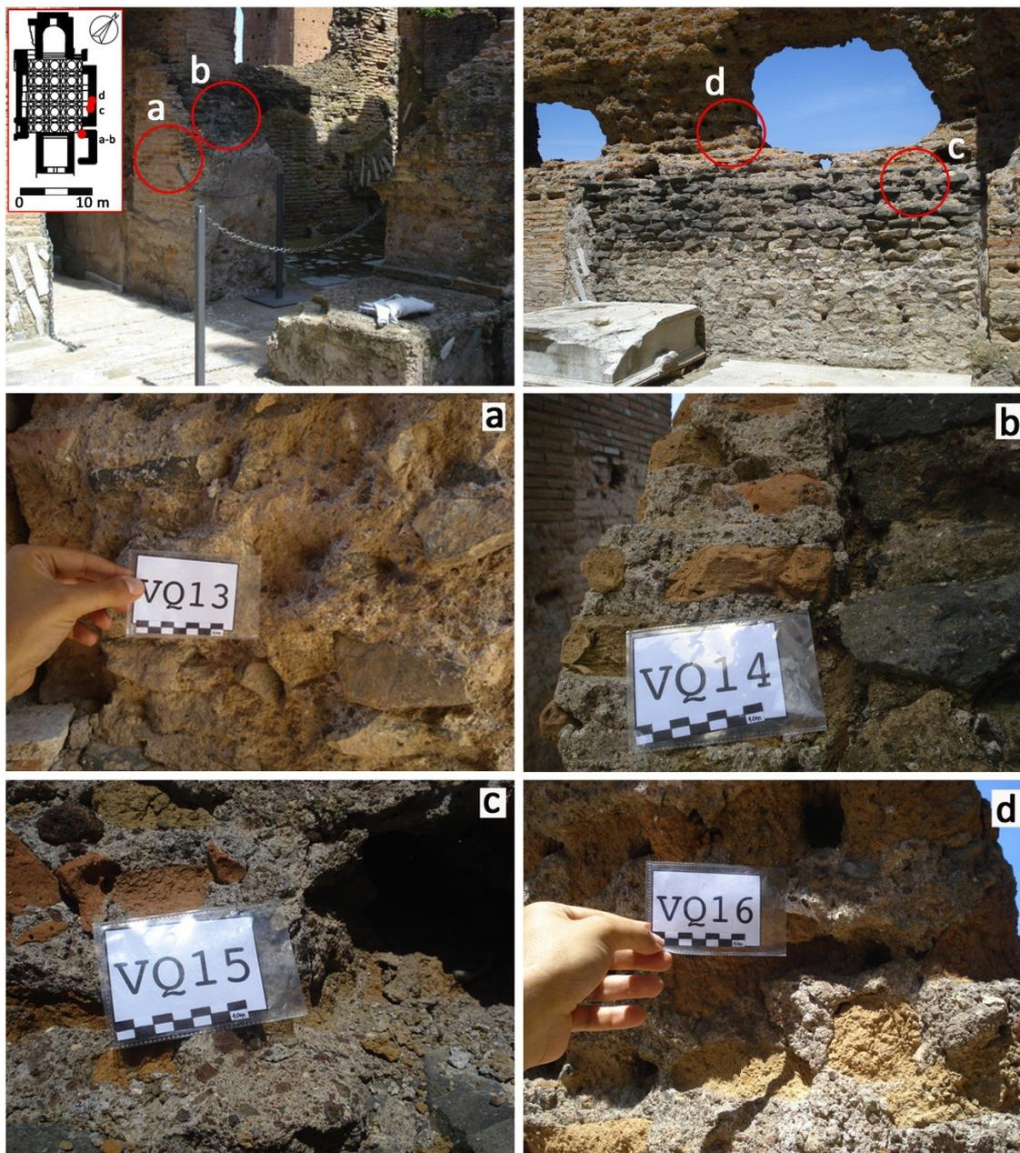
Figura 13. In alto foto dei paramenti murari dell'area termale del *Frigidarium* dai quali sono stati prelevati i campioni VQ13, VQ14, VQ15 e VQ16.
