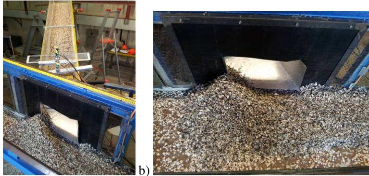
**Figura 6.15** Depositi in condizioni drenate relativi alla prova sperimentale n.3 ad esperimento concluso: a) vista della canaletta B; b) vista dall'alto della canaletta A in corrispondenza della sezione di sbocco della canaletta B.
