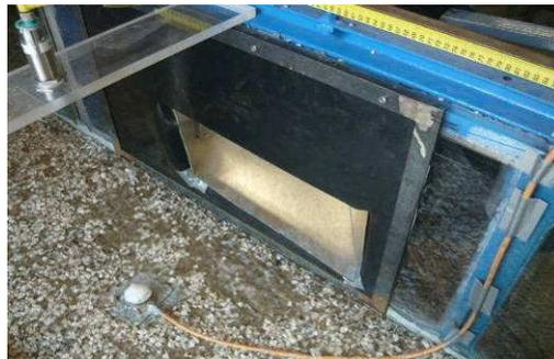
*Figura 5.9* Dispositivo di collegamento alla canaletta principale (canale A) che consente di variare l'angolo di confluenza evitando al contempo la fuoriuscita di acque e di sedimenti della colata.
