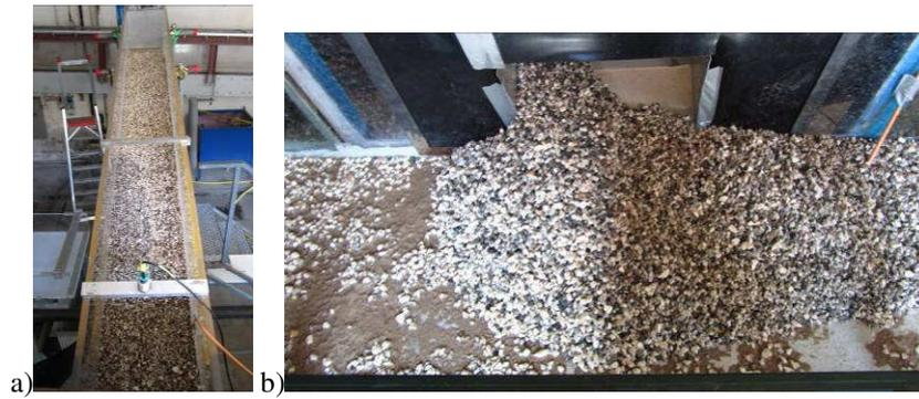
**Figura 6.108** Depositi in condizioni drenate relativi alla prova sperimentale n.19 ad esperimento concluso: a) vista della canaletta B; b) vista dall'alto della canaletta A in corrispondenza della sezione di sbocco della canaletta B.
