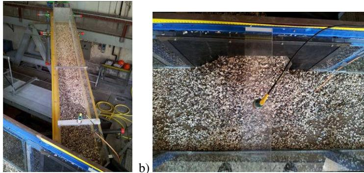
**Figura 6.2** Depositi in condizioni drenate relativi alla prova sperimentale n.1 ad esperimento concluso: a) vista della canaletta B; b) vista dall'alto della canaletta A in corrispondenza della sezione di sbocco della canaletta B.
