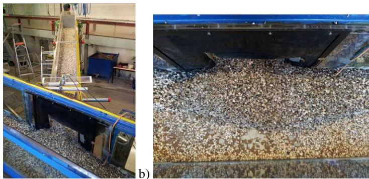
**Figura 6.16** Depositi in condizioni drenate relativi alla prova sperimentale n.3 ad esperimento concluso: a) vista della canaletta C; b) vista dall'alto della canaletta A in corrispondenza della sezione di sbocco della canaletta C.
