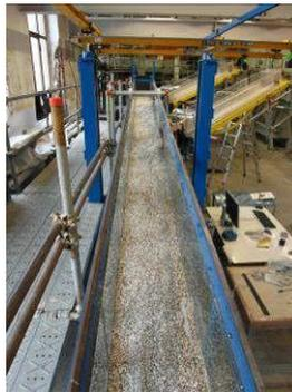
**Figura 6.33** Vista generale dei depositi lungo la canaletta A in condizioni drenate relativi alla prova sperimentale n.6 ad esperimento concluso.
