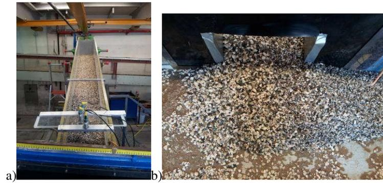
**Figura 6.96** Depositi in condizioni drenate relativi alla prova sperimentale n.17 ad esperimento concluso: a) vista della canaletta B; b) vista dall'alto della canaletta A in corrispondenza della sezione di sbocco della canaletta B.
