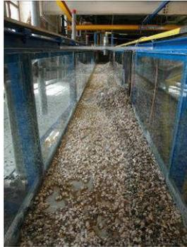
**Figura 6.67** Vista generale dei depositi lungo la canaletta A in condizioni drenate relativi alla prova sperimentale n.12 ad esperimento concluso.
