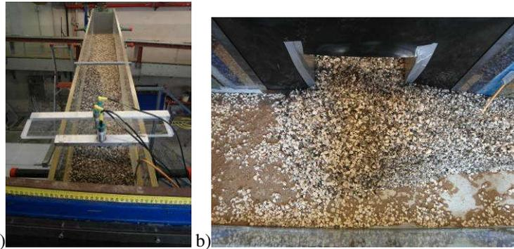
**Figura 6.90** Depositi in condizioni drenate relativi alla prova sperimentale n.16 ad esperimento concluso: a) vista della canaletta B; b) vista dall'alto della canaletta A in corrispondenza della sezione di sbocco della canaletta B.
