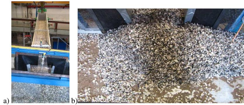
**Figura 6.102** Depositi in condizioni drenate relativi alla prova sperimentale n.18 ad esperimento concluso: a) vista della canaletta B; b) vista dall'alto della canaletta A in corrispondenza della sezione di sbocco della canaletta B.
