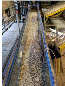
**Figura 6.61** Vista generale dei depositi lungo la canaletta A in condizioni drenate relativi alla prova sperimentale n.11 ad esperimento concluso.
