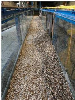
**Figura 6.77** Vista generale dei depositi lungo la canaletta A in condizioni drenate relativi alla prova sperimentale n.14 ad esperimento concluso.
