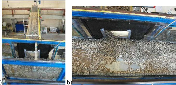
**Figura 6.79** Depositi in condizioni drenate relativi alla prova sperimentale n.14 ad esperimento concluso: a) vista della canaletta C; b) vista dall'alto della canaletta A in corrispondenza della sezione di sbocco della canaletta C.
