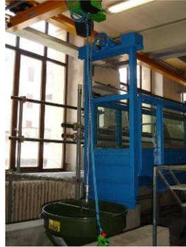
**Figura 5.6** Sistema carroponte e paranco a cui è attaccata la benna utilizzata come contenitore per il ghiaino da movimentare.
