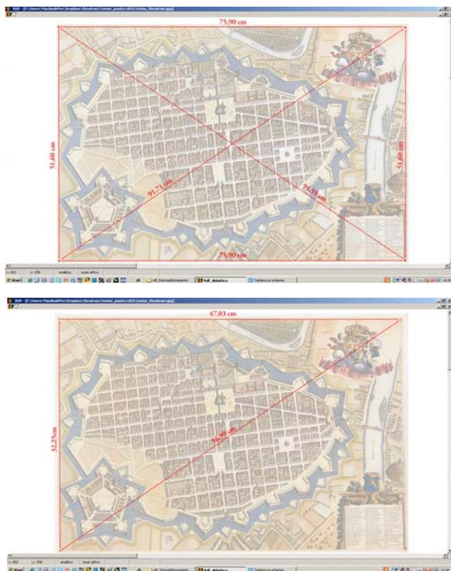
I. Rettifica delle deformazioni - vertici e diagonali - della tavola di Torino del *Theatrum Sabaudiae* con software di raddrizzamento in base al rilievo centimetrico effettuato sugli originali.
