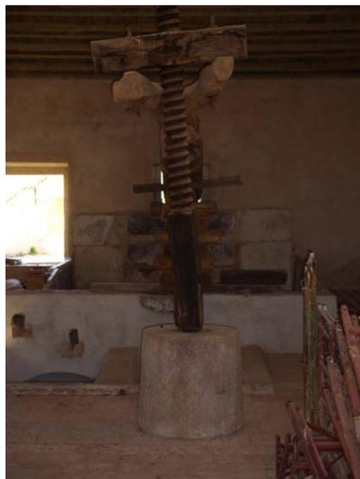
Figura 71 - Zona di torchiatura: torchio a bilancia con vincolo a muro
