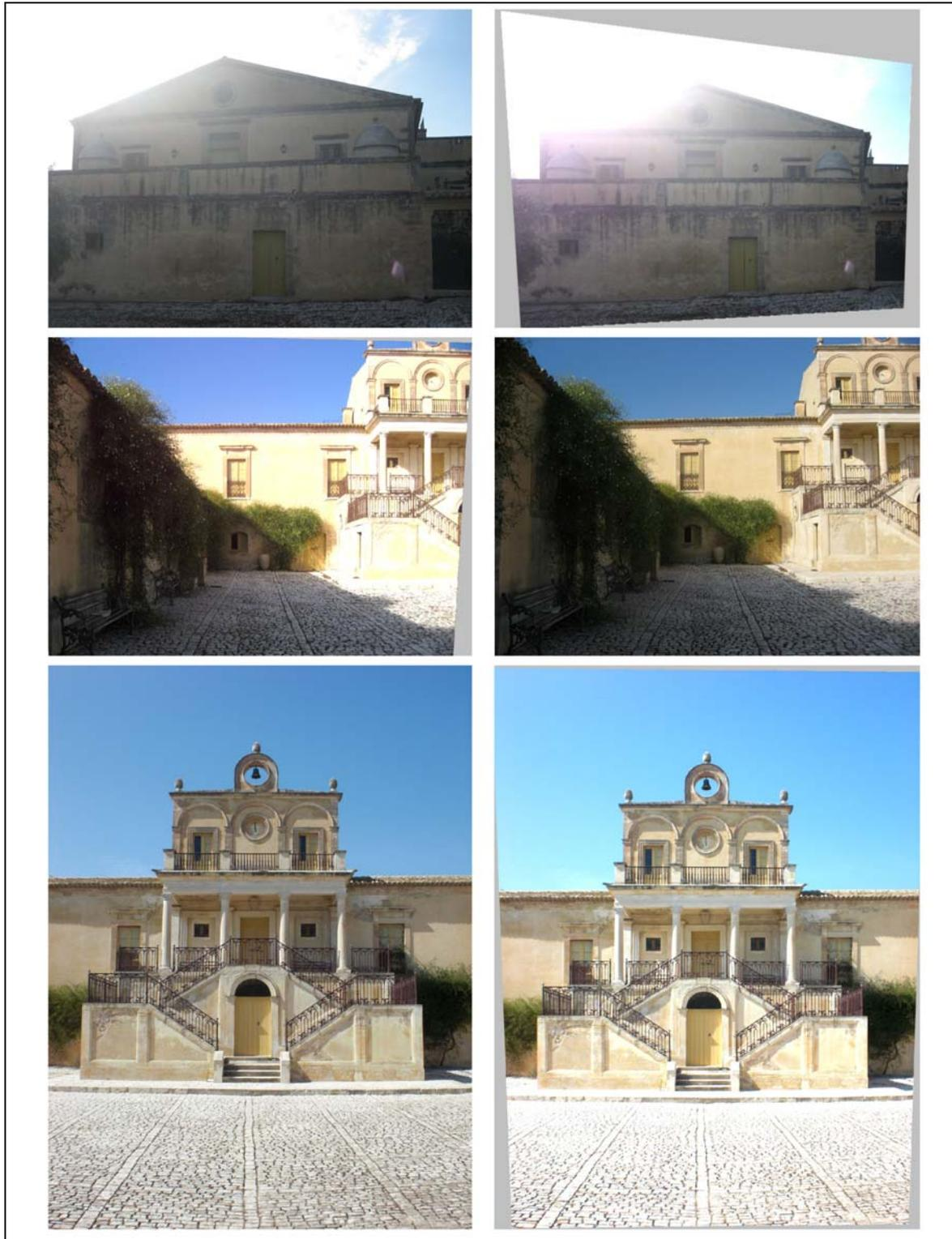
Figura 129 - Raddrizzamenti di immagini raster della casa padronale: prospetti sud ed est. A sinistra sono mostrate le fotografie originali e a destra le fotografie dopo il processo di raddrizzamento.
