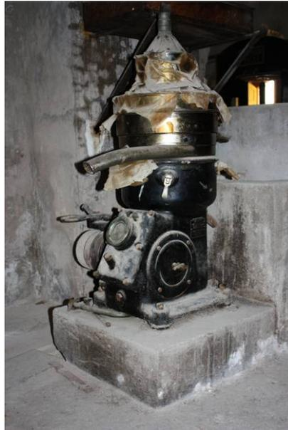
Figura 88 - Separatore centrifugo per mosto oleoso
