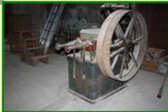
*Pompa idraulica per le superpresse*
