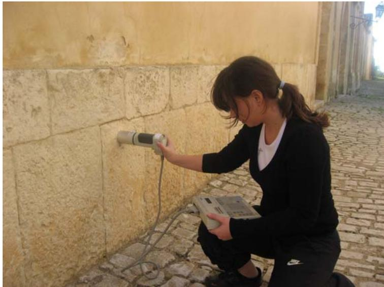
Figura 124 - Rilievo del colore con il colorimetro Minolta CR-310.
