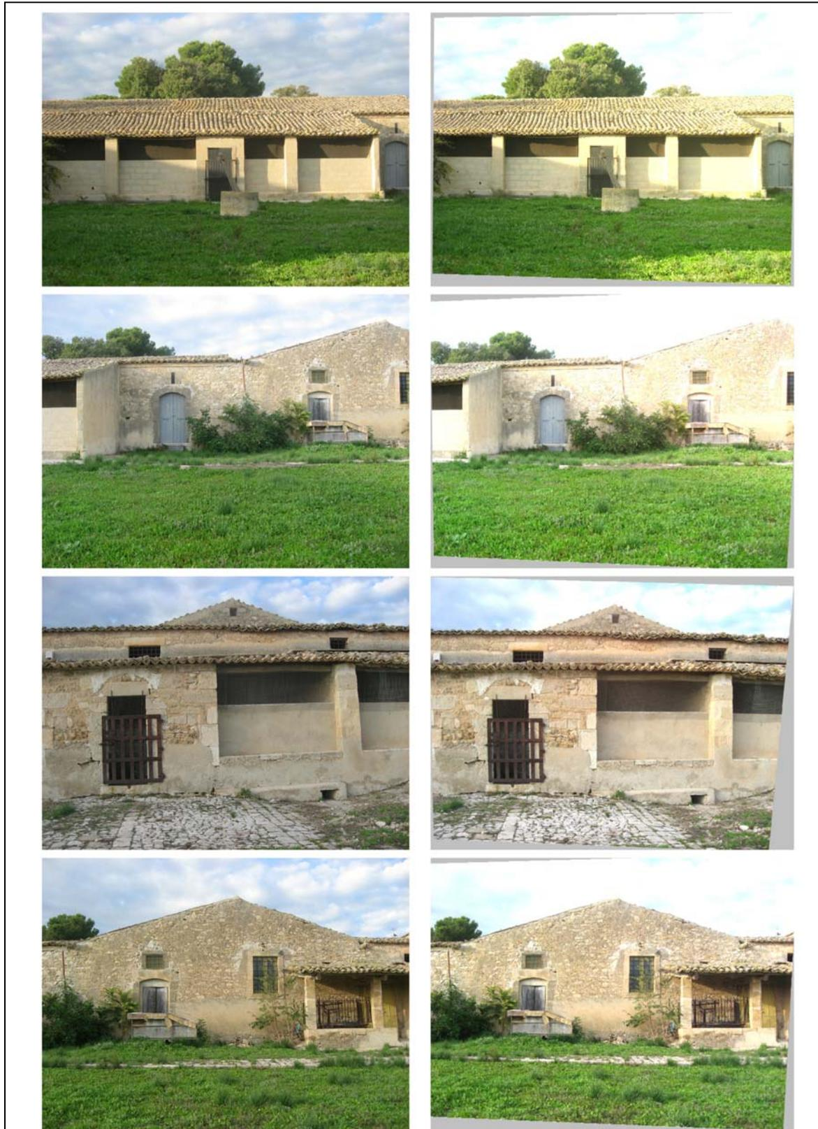
Figura 128 - Raddrizzamenti delle immagini raster di fabbricati disposti a nord della corte rurale. A sinistra sono mostrate le fotografie originali e a destra le fotografie dopo il processo di raddrizzamento.
