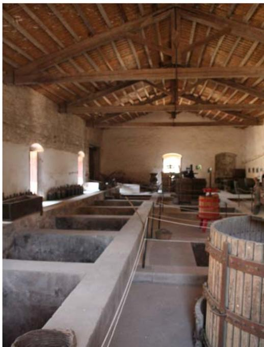
Figura 70 - Zona di torchiatura. Torchi “u canazzino” su base in acciaio o lapidea.
