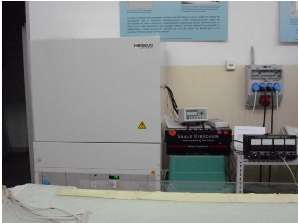
Figura 4.2: Camera termica adoperata per le prove.
