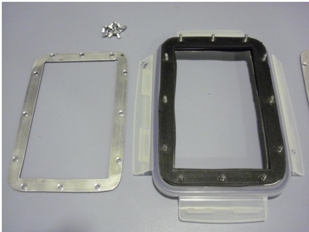
Figura 4.4: Sistema per la chiusura ermetica dei box.
