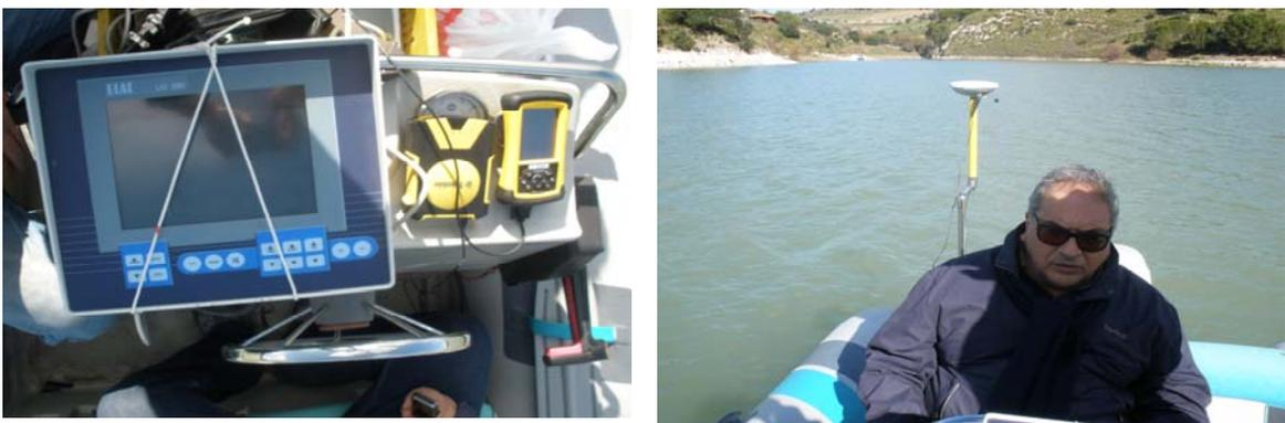
**Figura 3.24 Strumentazione a bordo (sinistra) Antenna GPS installata sul gommone coassialmente all'ecoscandaglio utilizzato per i rilievi batimetrici sul serbatoio Ragoletto (destra).**
