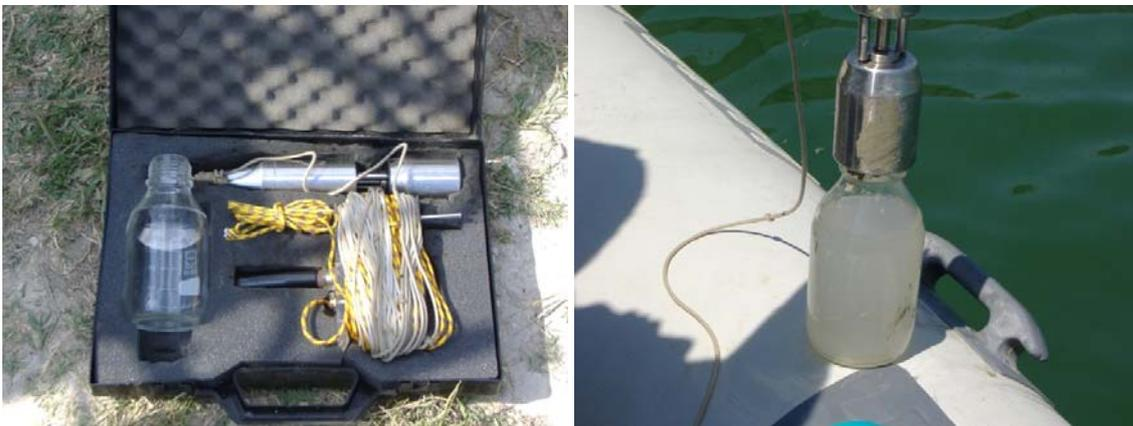
**Figura 3.47** Strumentazione per il campionamento delle acque a varie profondità
