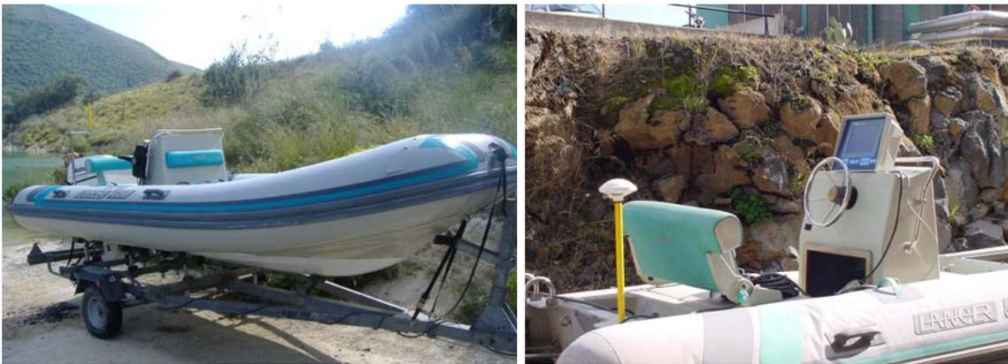
**Figura 3.23 Imbarcazione utilizzata per i rilievi batimetrici**
