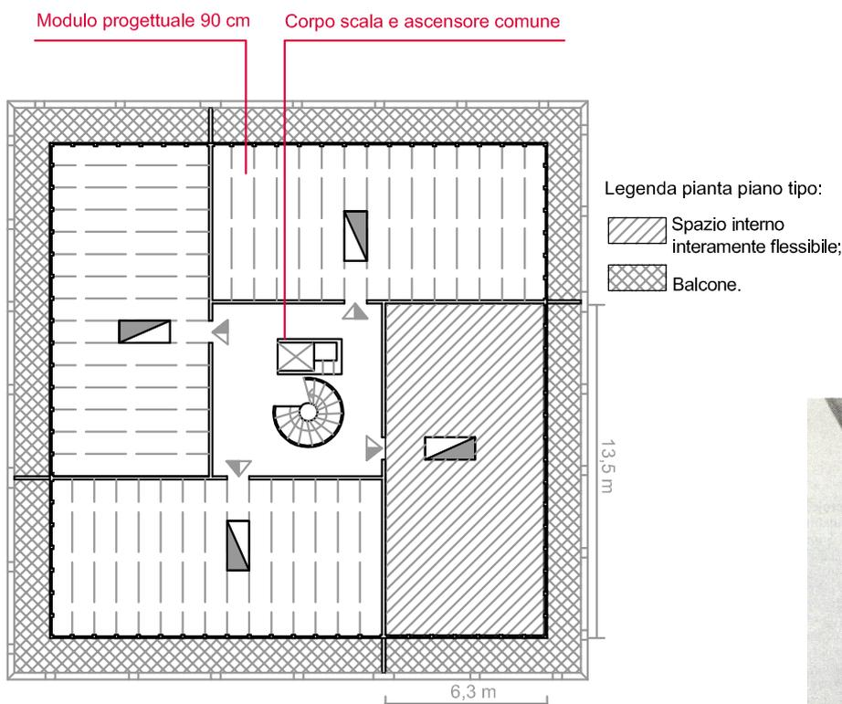
Fig.2 Pianta piano tipo con individuazione dei moduli di 90 cm.
