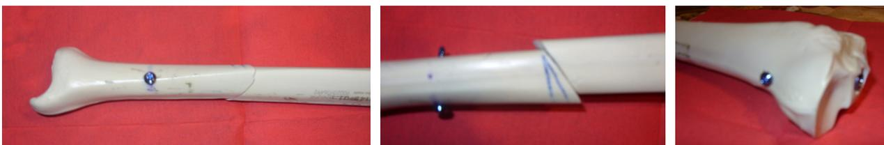
Figura 39: montaggio dinamico del chiodo e rima di frattura
