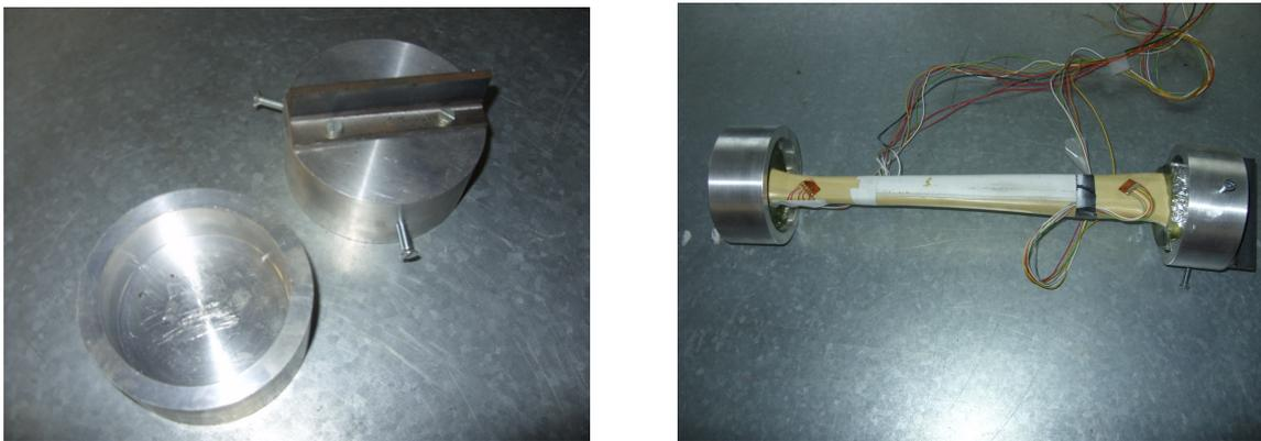
Figura 29: supporti per il fissaggio della tibia
