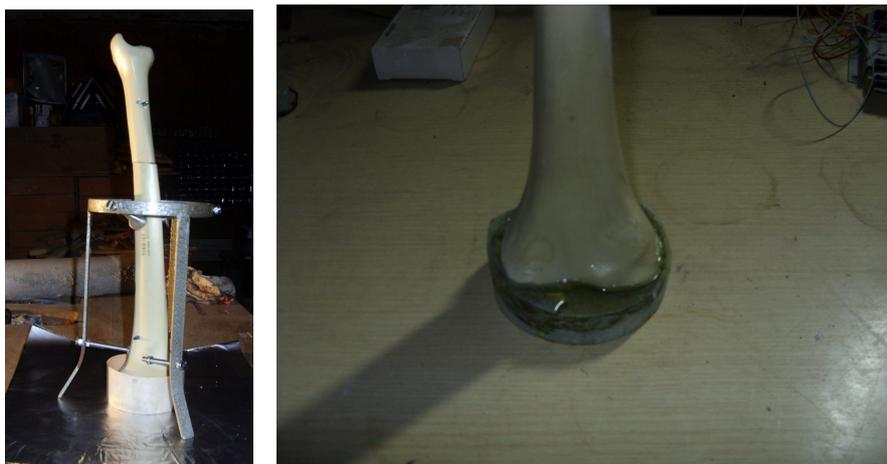
Figura 30: Allineamento del campione durante la colata di resina e particolare della resina indurita
