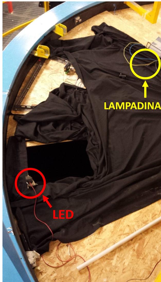
Figura 4.31: Fotografia dell'apertura tramite cui il PMT osserva le turbolenze dell'acqua generate dal vento. Sono indicate anche le due sorgenti utilizzate per illuminare l'acqua.
