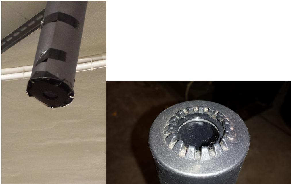
Figura 4.24: Fotografia della lente collimatrice montata alla base del fototubo e dettaglio della lente.
