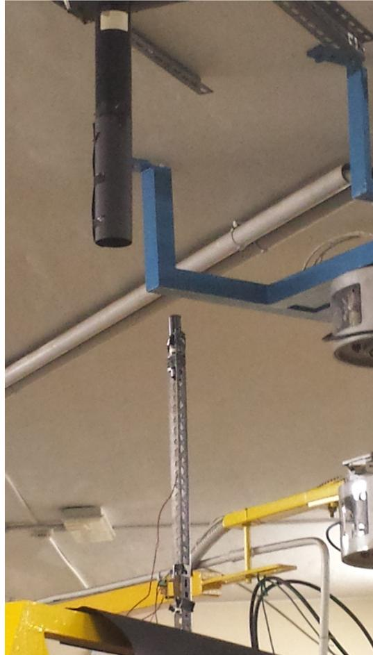
Figura 3.11: Fotografia del sistema cilindretto-LED UV per la riproduzione di eventi di piccole dimensioni, come meteore e raggi cosmici. È possibile vedere il cilindretto ancorato in cima ad un supporto metallico, con la luce del LED UV orientata verso l'alto e il fototubo ancorato al soffitto; con la rotazione della vasca i due sistemi si incrociano, creando così una striscia di luce.
