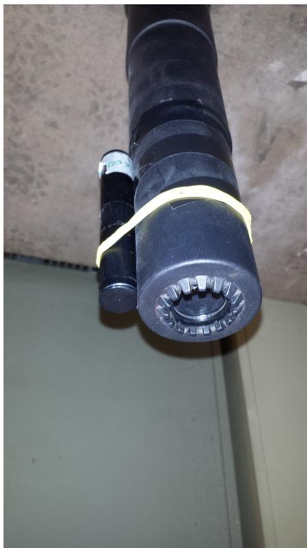
Figura 4.41: Configurazione del LED posto in parallelo al tubo collimatore del PMT, tale da creare uno spot verticale nella riflessione della luce sull'acqua.
