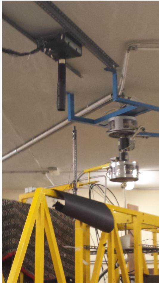
Figura 4.17: Fotografia del dettaglio della scatola con il fototubo e del cannoncino col LED UV dopo l'avvicinamento.
