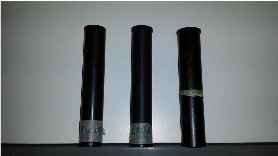
Figura 4.15: Fotografia dei cannoncini, corredati di tappi forati con aperture differenti, per la riproduzione di eventi luminosi concentrati.
