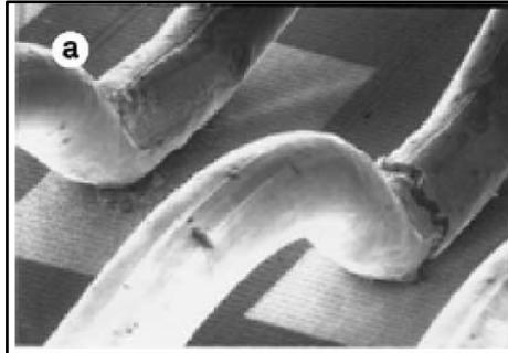
Figura 142 - Crack nel caso di un legame doppio
