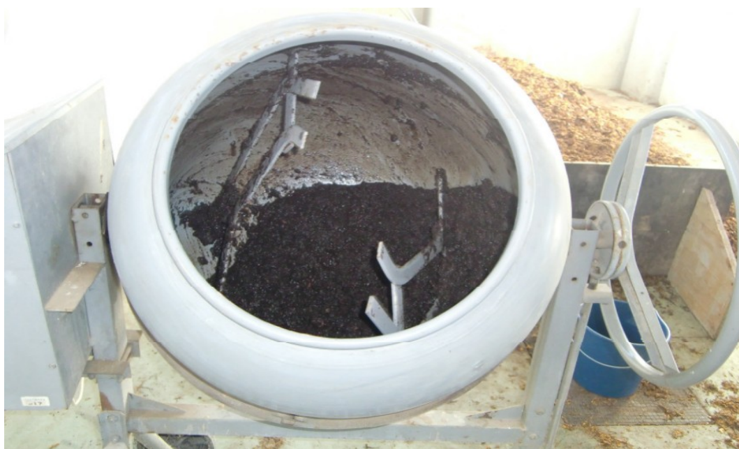
Foto 4 – Lavaggio del compost all'interno di una betoniera.
