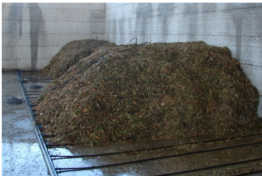
Foto 2 – Cumuli posizionati al di sopra del sistema di aerazione forzata.
