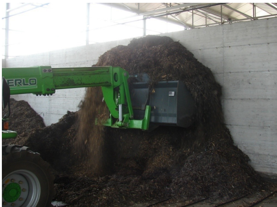
Foto 3 – Rivoltamento meccanico della massa sottoposta a compostaggio.
