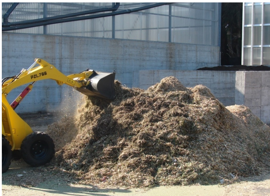
Foto 1 – Miscelazione dei residui di potatura trinciati.
