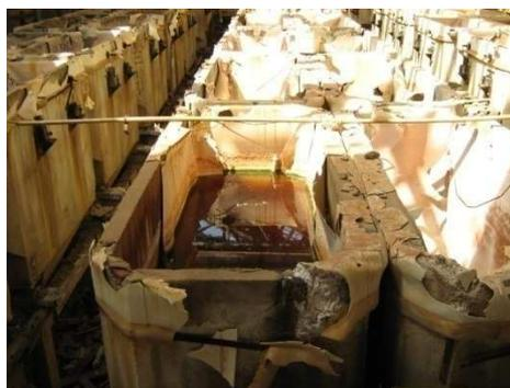
Fig.107: Particolare delle celle per l'elettrolisi.
