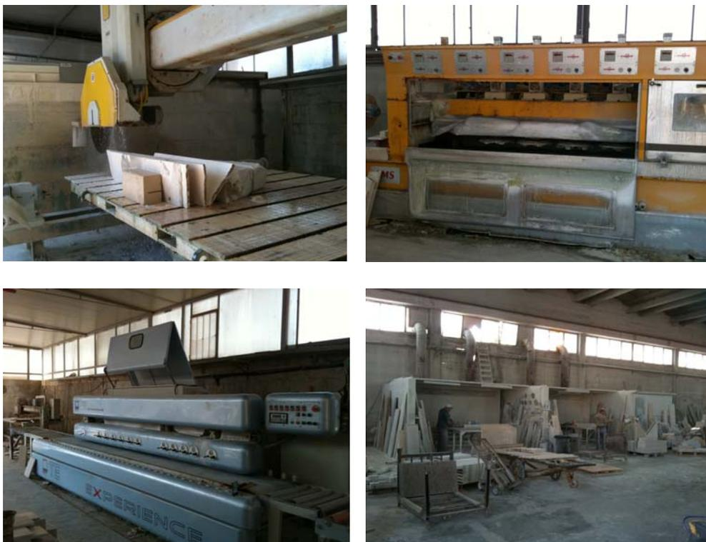
Figura 16 - La macchina tagliatrice, la levigatrice, la bordatrice e le fasi di rifinitura (per gentile concessione della "Fiorito Marmi s.r.l.")
