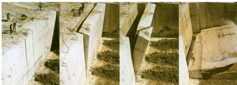
Figura 4 – Fasi del taglio primario e del ribaltamento a terra<sup>8</sup>
