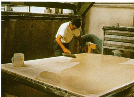
Figura 3 - Operazione di retinatura su una lastra di marmo<sup>21</sup>
