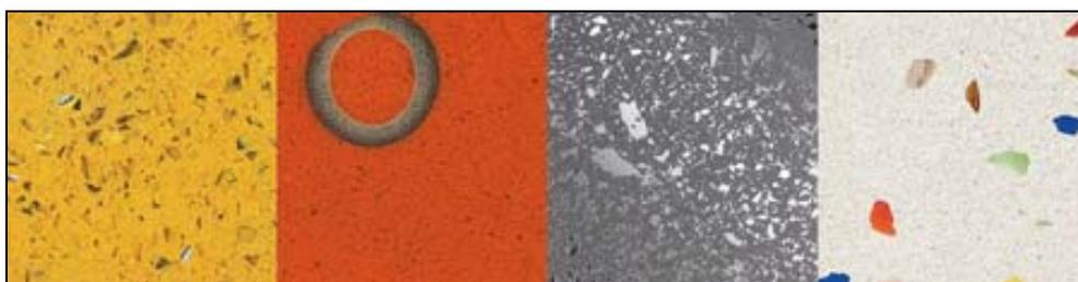
Figura 4 - Texture di pietre artificiali composite per Stone Italiana Spa, in ordine: quarzo-resina, con inserti di bambù, effetto metallizzato, con vetro colorato<sup>13</sup>
