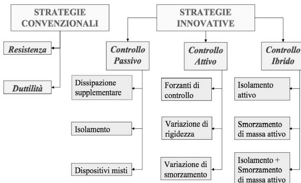
Figura 1 – Strategie di protezione sismica delle strutture<sup>66</sup>
