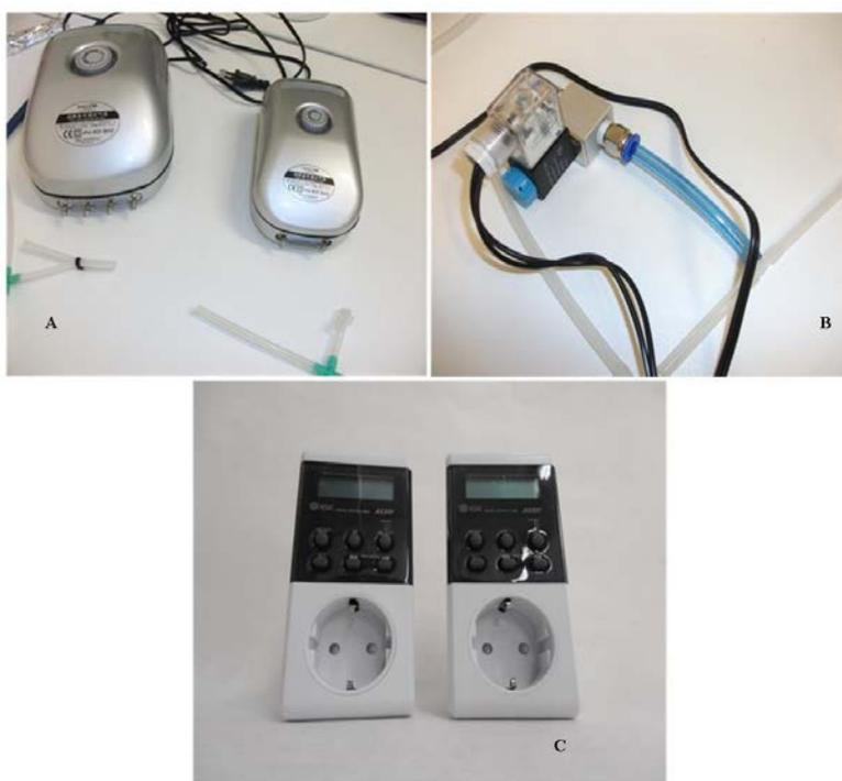
Figura 21 A: pompe per il funzionamento del sistema; B: elettrovalvola utilizzata per favorire la fuoriuscita di aria dal sistema; C: timer utilizzati per attivare il sistema.
