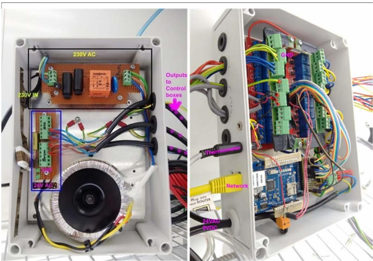
Figura 19 Particolare delle scatole di controllo del sistema
