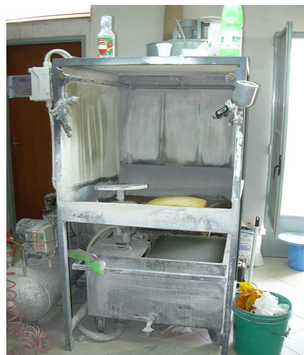
Figura 5.19 – Attrezzature per smaltare (Immersione e cabina aerografa a spruzzo)
