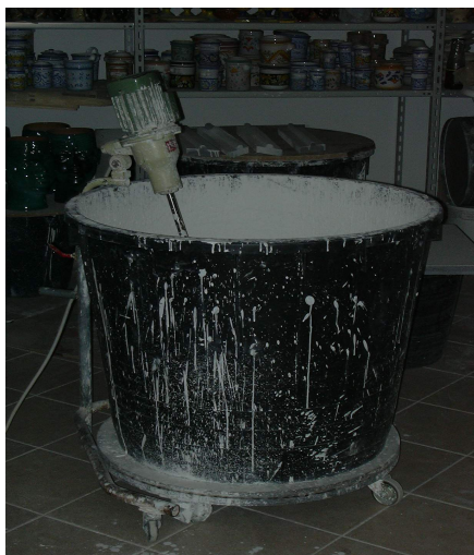
Figura 5.20 - Smaltatura della terracotta (tecnica ad immersione)
