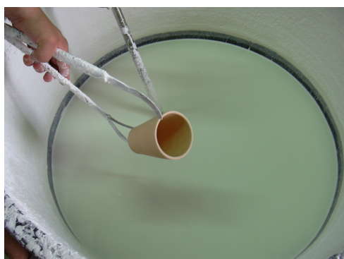
Figura 5.20 - Smaltatura della terracotta (tecnica ad immersione)
