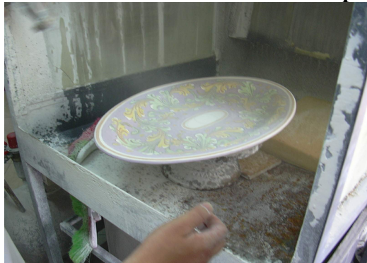
Figura 5.23 – Applicazione della cristallina con tecnica a spruzzo (cabina aerografa)
