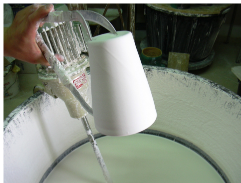
Figura 5.20 - Smaltatura della terracotta (tecnica ad immersione)
